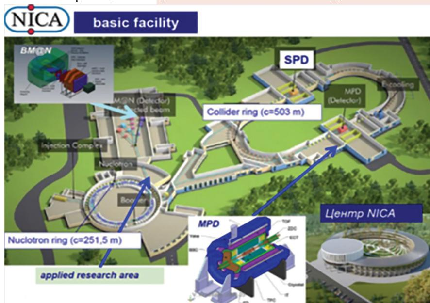
Ведутся активные работы по созданию сверхпроводящего коллайдера протонов и тяжёлых ионов в рамках реализации Мегасайенс-проекта NICA на базе Объединённого института ядерных исследований (ОИЯИ). В рамках эксперимента BM@N по исследованию барионной материи создан трековый детектор и проведён первый сеанс по набору статистики.
