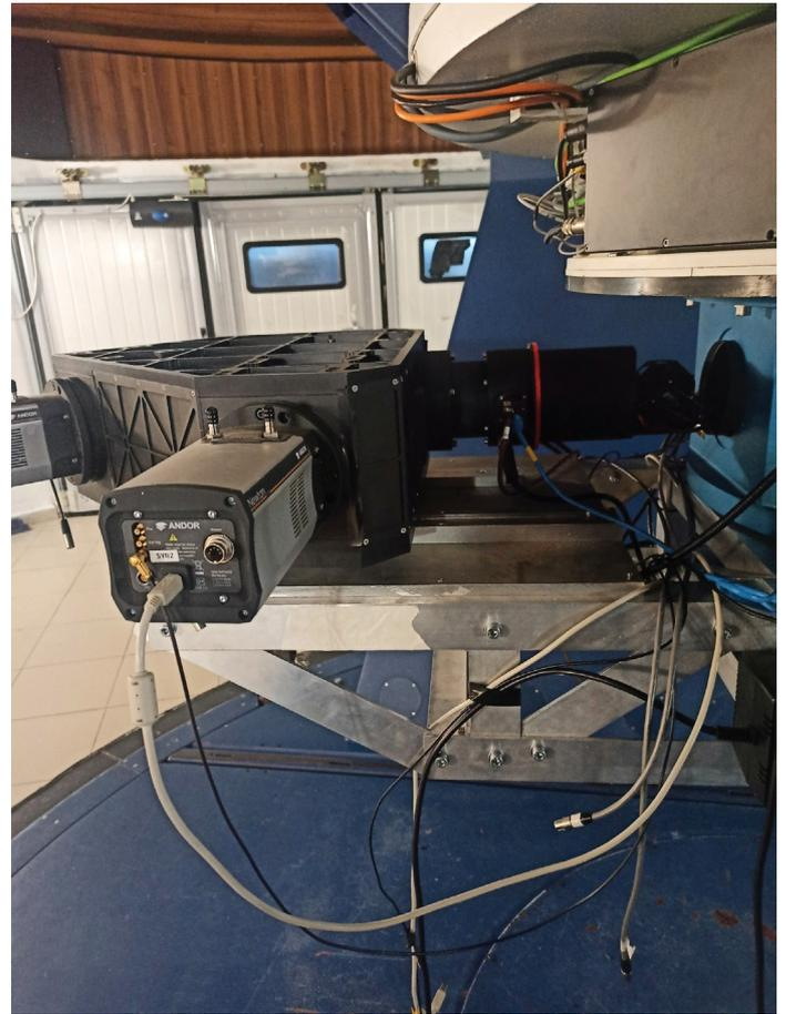
*Штатный спектрограф ТДС для 2.5-м телескопа МГУ*
